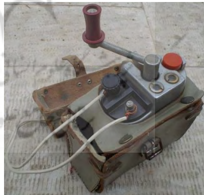
تصویر شماره (۳): نمونه آزمایش گر مدار الکتریکی، ماشین انفجار، چاشنی الکتریکی
